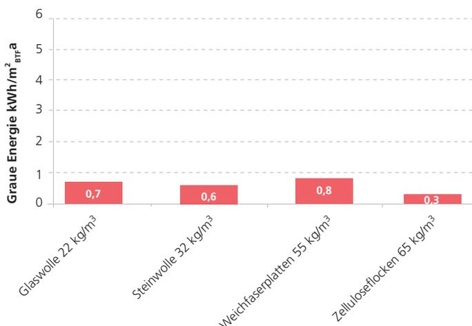
Die Zelluloseflocken profitieren vom hohen Recyclinganteil und von der einfachen und energiearmen Weiterverarbeitung des Altpapiers. Absolut betrachtet mögen alle Materialien wenig graue Energie aufweisen, alleine mit einer optimierten Materialwahl lässt sich die graue Energie innerhalb dieser Auswahl wiederum halbieren.
