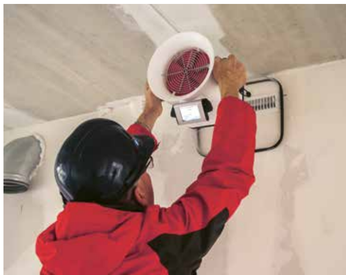
Bild 12.1: Volumenströmmessgerät mit Nulldruckkompensation. (Quelle: ACIN instrumenten bv, BG Rijswijk NL)
