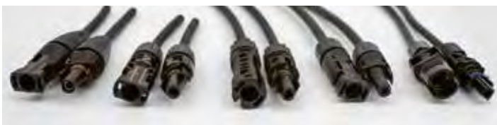
Bild 9.8: Fünf verschiedene Fabrikate von PV-Modul-Steckern. Sie sind untereinander nicht kompatibel, auch wenn sie mechanisch zusammensteckt werden können.
