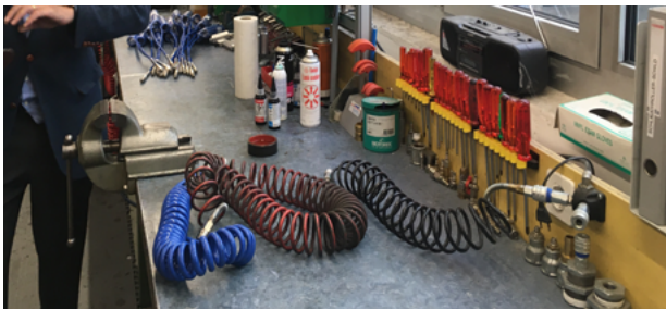
Spiralschläuche nur für die letzten Meter einsetzen.
